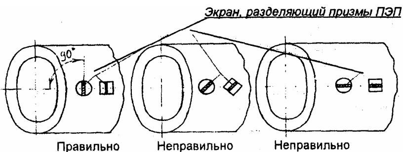
Рис.1 Схема установки раздельно-совмещенных ПЭП при измерении толщины стенок трубчатых элементов
